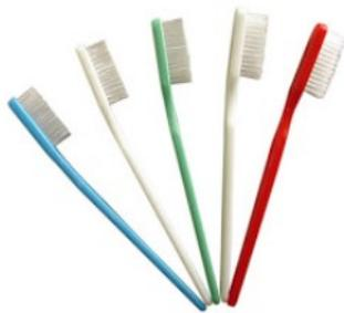
**CEPILLOS:** Los de cerdas delgadas, para limpiar finamente. Junto con el alcohol izo propílico se usan para limpiar los contactos electrónicos
